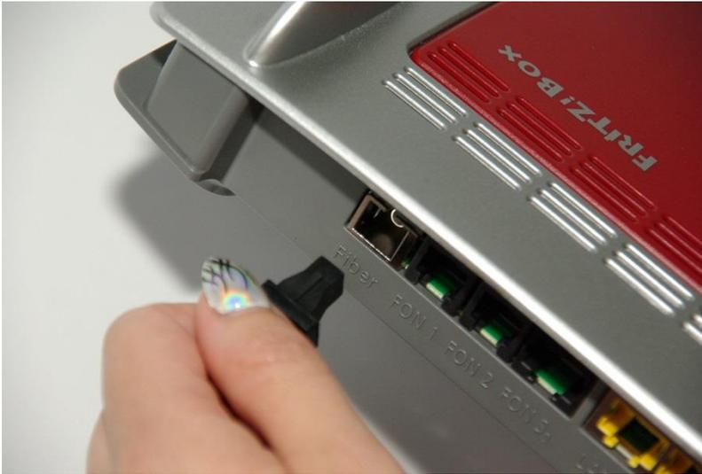
Die Staubschutzkappe von der Glasfaserbuchse der FRITZ!Box entfernen.
