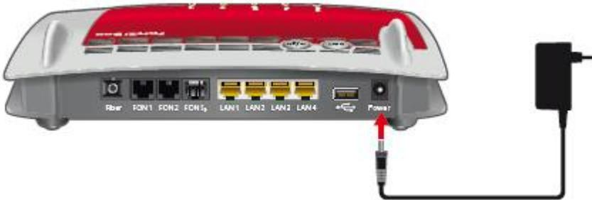
Schließen Sie die Fritz!Box an den Strom an. Die Leuchtdiode „Power“ beginnt zu blinken.
