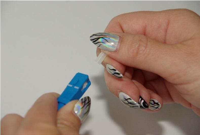
Die Staubschutzkappe vom Kabelstecker entfernen.
