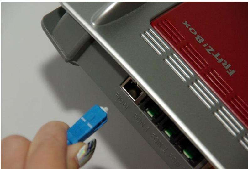
Den Kabelstecker in die Glasfaserbuchse der FRITZ!Box stecken.
