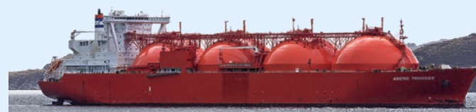
Innen eiskalt, außen hitzebeständig: Zurzeit erfüllen riesige kugelförmige Tanks diesen Anspruch, die wegen ihrer Form jedoch bald von besser händelbaren Konstruktionen abgelöst werden sollen.
